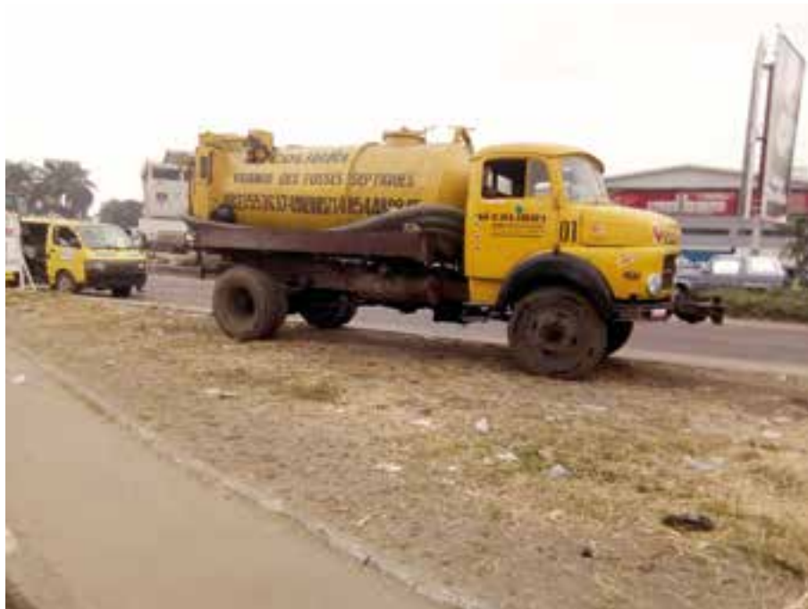
Image 3 : Véhicule de vidange de fosse septique
